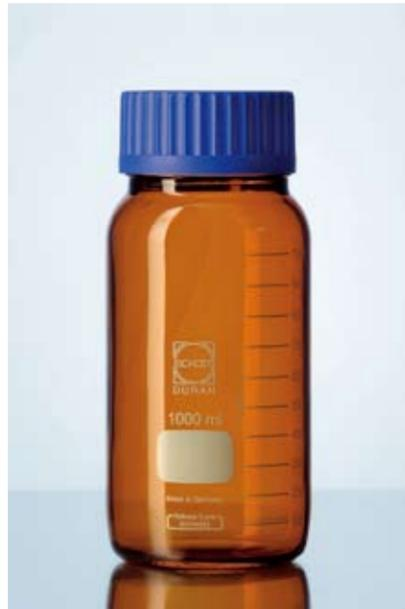
SCHOTT DURAN®实验室棕色玻璃瓶可防紫外线保护瓶内物质，本瓶适用于盛放易感光物质，并可长期贮存各种物质。
